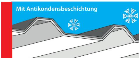
ISO\*-Therm Antikondensbeschichtung verhindert Kondenswasserbildung.
